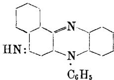
Durch Reduktion mit Zinnchlorür und Salzsäure in alkoholischer Lösung wird der Körper ganz glatt in Rosindulin umgewandelt; die dabei jedenfalls auftretenden Zwischenprodukte wurden nicht isoliert. In der Benzol-Reihe entspricht dieser Reaktion die Verwandlung des Trinitrophenyl-phenyl-*o*-phenylen-
